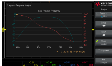
用于频响分析的伯德图 (Bode plot) 功能
