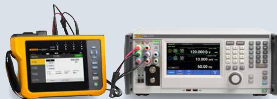
5530A 基本型校准器可满足手持式数字多用表和功率仪表的校准要求
